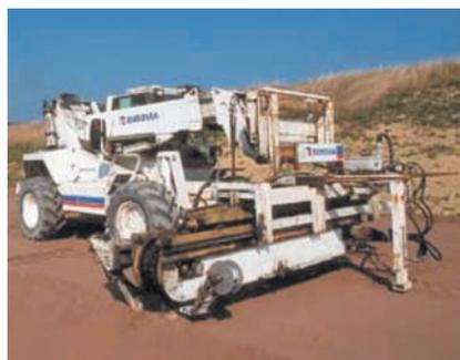
Tanto el desplazamiento de la viga móvil como el del elemento de corte se controlan electrónicamente. Los dos modelos existentes en la actualidad tienen un ancho de trabajo mínimo de 2 m y máximo de 5 m.
