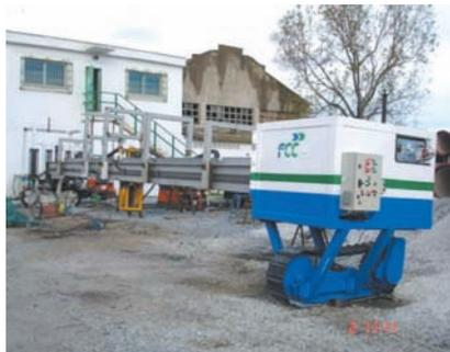
FCC diseñó una máquina capaz de avanzar sobre bermas no excesivamente compactadas ni niveladas, y situarse en los puntos adecuados, realizando el corte de la capa tratada por medio de un *ripper*, que, a su vez, inyecta la emulsión.
