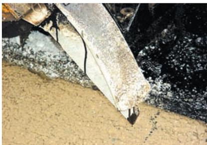
– Un brazo articulado, que introduce el elemento de corte en la capa y le desplaza a velocidad constante en todo el ancho de trabajo. A través de un circuito hidráulico, se le proporciona la potencia requerida.
