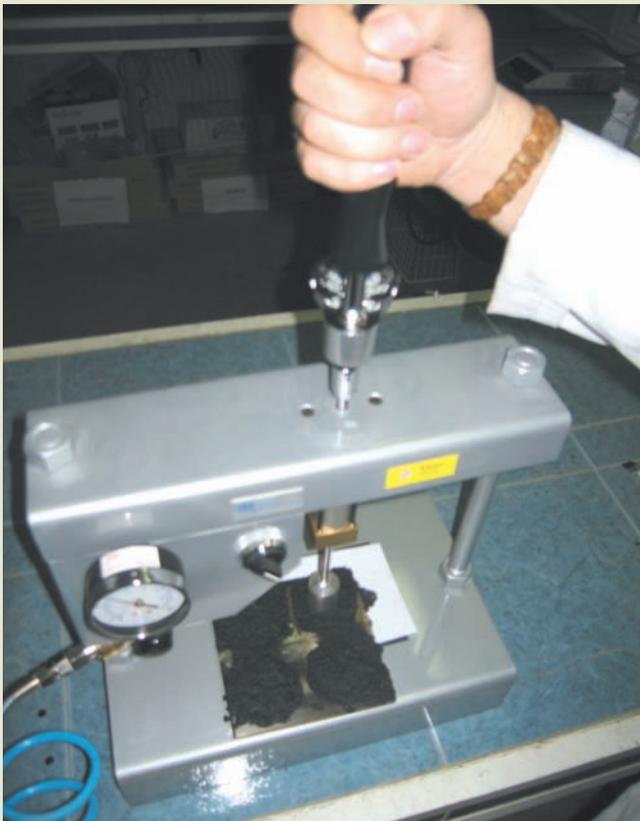
Foto 2. Ensayo para la determinación de la cohesión.
