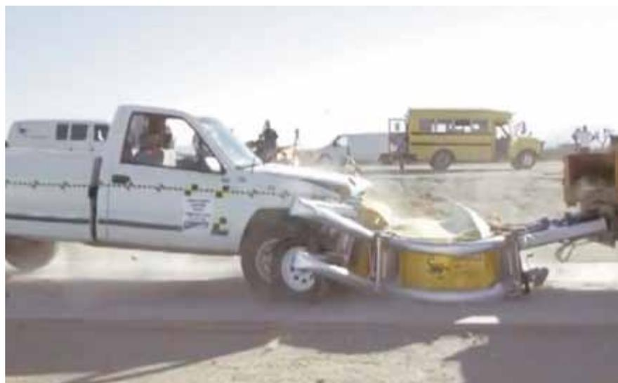
Prueba de un atenuador. Foto Traffix Devices Inc.
