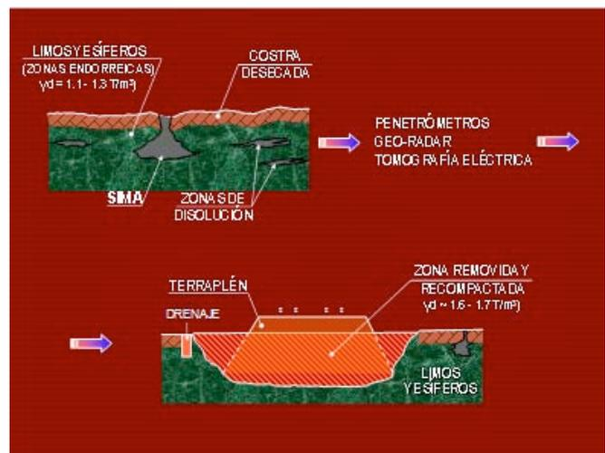
Figura 9. Excavación y recompactación de limos yesíferos colapsables.
