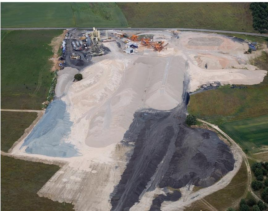
Foto 2. Instalación 2. Planta específica para reciclado en caliente de alta tasa. En primer término se pueden ver los acopios de material procedente de fresado de mezclas bituminosas.
