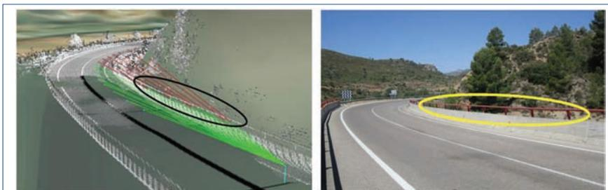
Figura 7. Proceso de localización del obstáculo visual en el sistema de referencia local bidimensional  $X'Y'$ .
