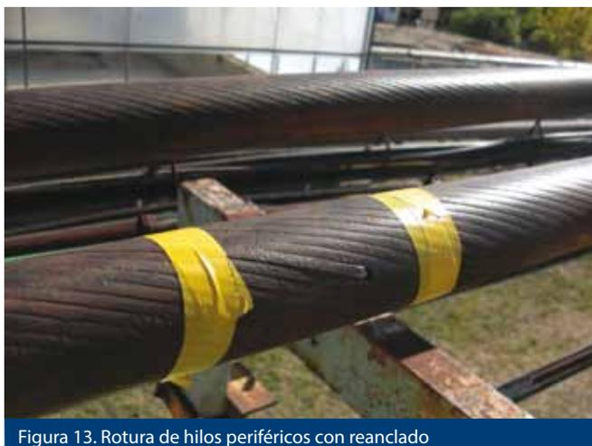
Figura 13. Rotura de hilos periféricos con reanclado
