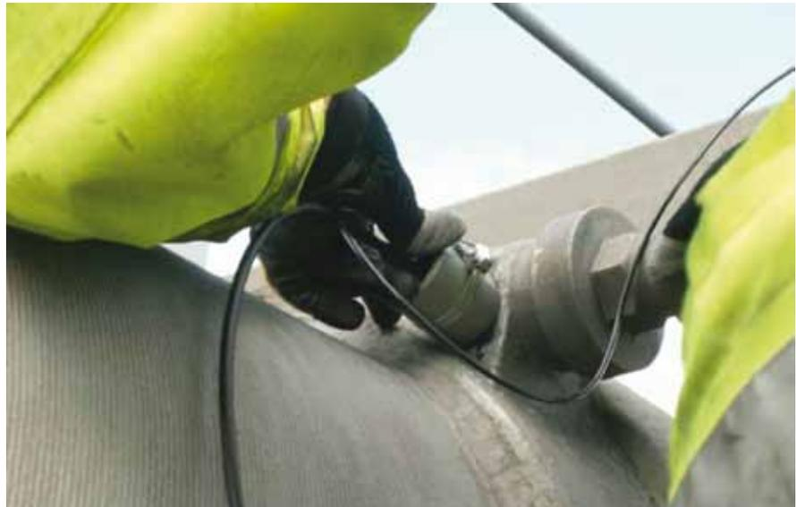
Figura 24. Puentes sobre el estuario del Forth - Escocia. Acelerómetro de sistema auscultación acústica desarrollado por advitam
