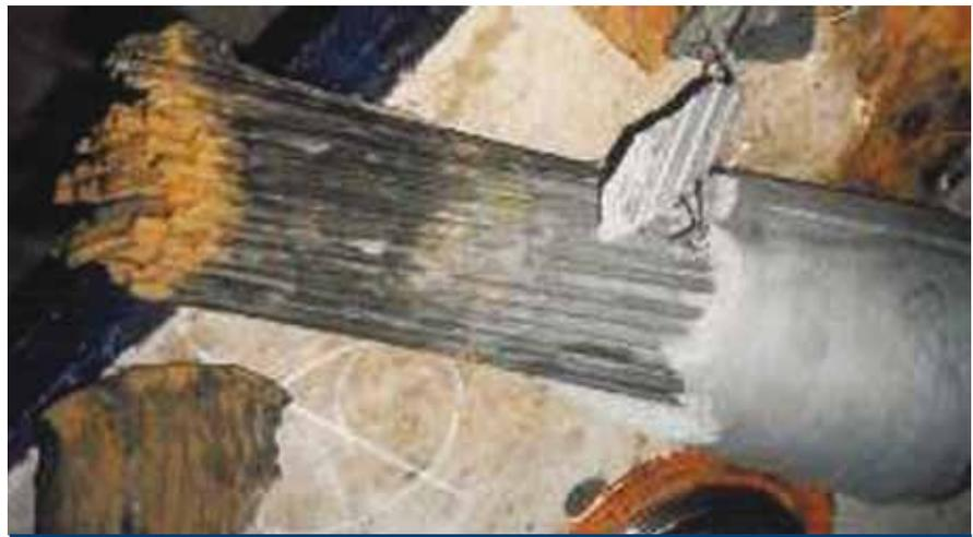
Figura 29. Detalle de la falla del tirante roto en Zárate
