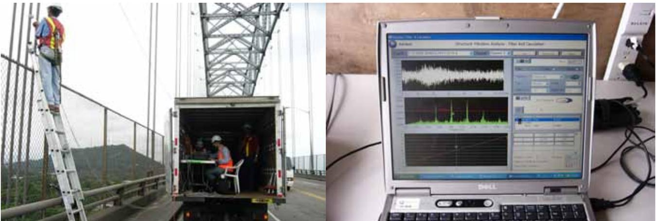
Figura 19. Medición de cuerda vibrante del puente las Américas
