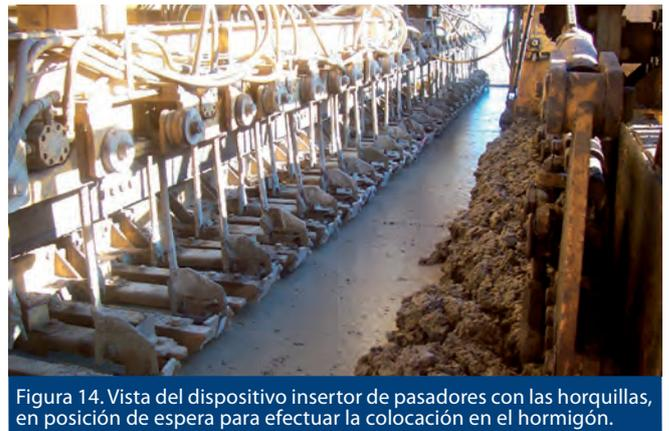
Figura 14. Vista del dispositivo insertor de pasadores con las horquillas, en posición de espera para efectuar la colocación en el hormigón.
