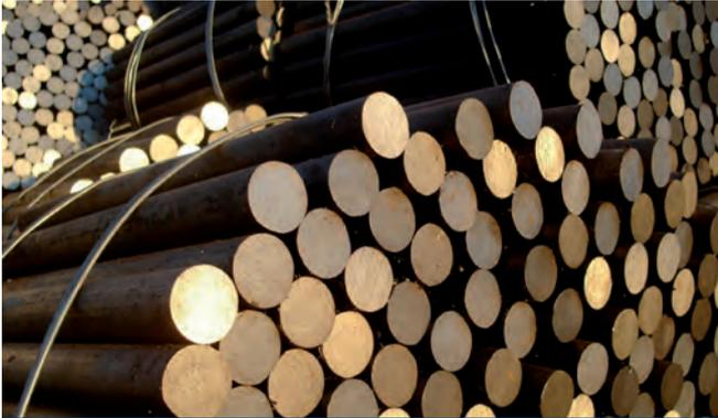
Figura 11. Los pasadores tienen usualmente un diámetro de 25 a 32 mm. El corte de éstas debe ser necesariamente con sierra para garantizar la ausencia de imperfecciones en los extremos, lo que dificultaría el movimiento de la barra en la masa de hormigón.
