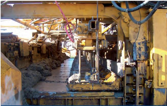
Figura 17. Vista de la regla oscilante y vibrante que lleva delante el rodillo de mortero fresco, cuya función es la corrección superficial de la masa de hormigón dañada por la inserción de los pasadores.
