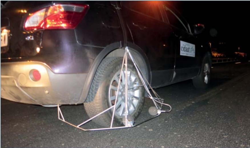
Figura 5. Sistema de medida CPX utilizado por la Fundación CIDAUT
