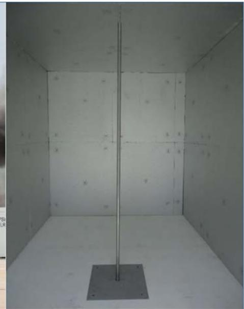
Figuras 2 y 3. Ensayo a escala real "Room Corner Test" con maquetas realizadas según ISO 9.705 y EN 14.390
