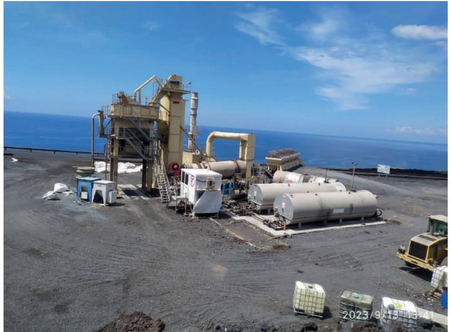
Figura 12. Planta asfáltica discontinua de tipo modular
