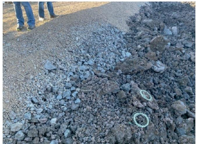
Figura 18. Termopares en el tramo de pruebas
