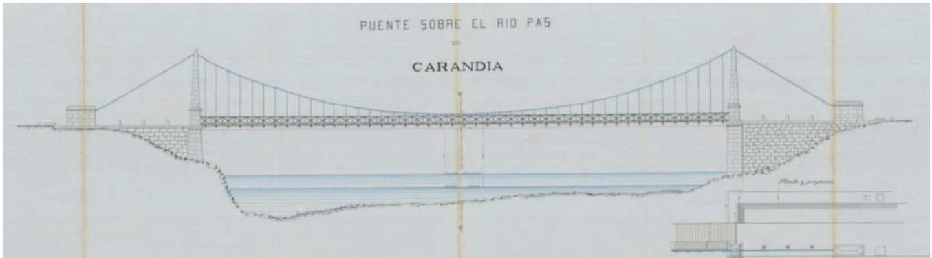
Figura 6. Plano del puente de Carandía, con las reformas de 1856.
