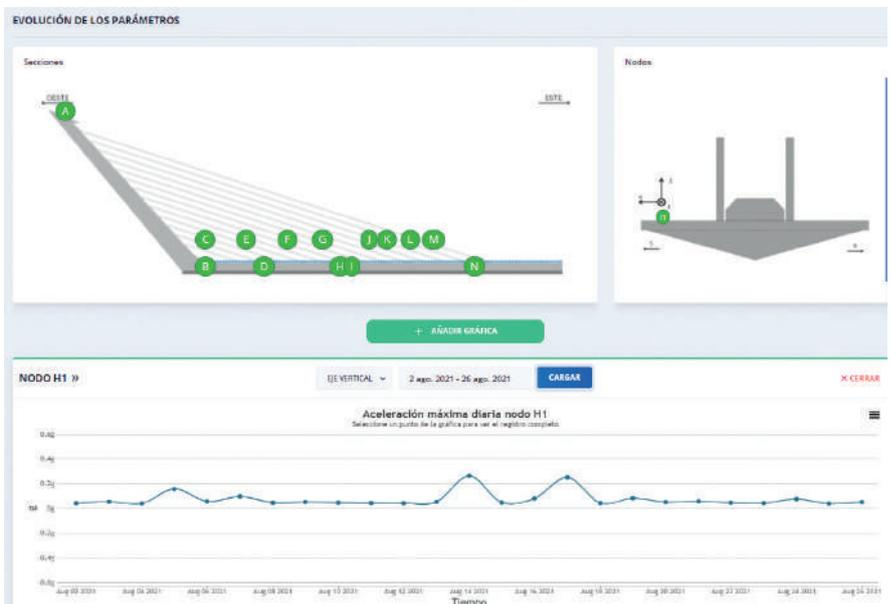
Figura 27. Salidas plataforma web auscultación Alamillo. Acelerómetro H1. IDVIA ( UPV ) 2.021
