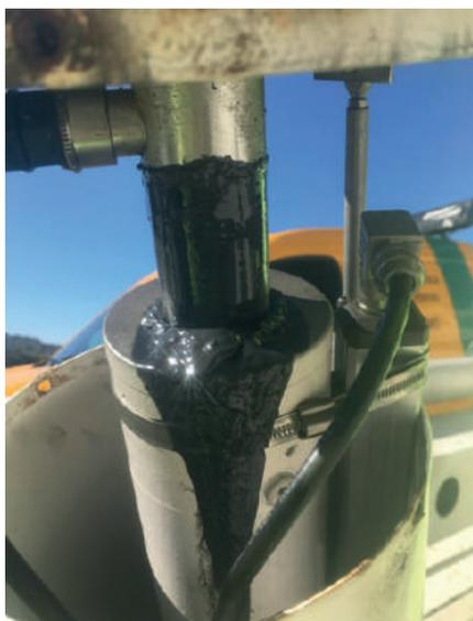
Figura 20. Amortiguador dinámico dañado. IMESAPI 2.021
