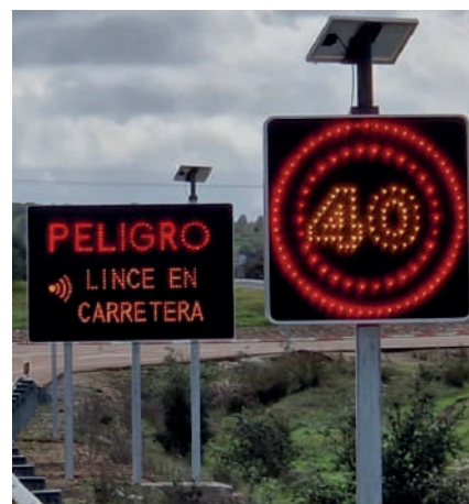
Figura 19. Sistema inteligente específico de advertencia ante la presencia inminente de un lince (especie protegida) en la vía
